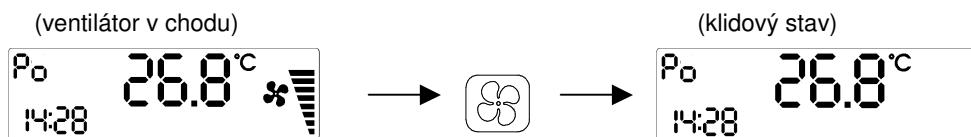
Stiskem tlačítka . Po doběhu ventilátoru přejde topení do klidu. Na displeji je v levém dolním rohu zobrazen aktuální čas a ve střední části displeje je zobrazena aktuální teplota zvoleného čidla. Během doběhu ventilátoru je možné měnit nastavení hodin nelze však zapnout topení.
