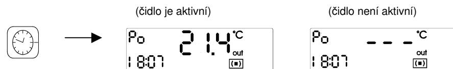
Je-li připojeno speciální externí čidlo, lze krátkým stiskem tlačítka zobrazit jeho teplotu. Teplota je zobrazována po dobu 4 s. Po uplynutí této doby se hodiny vrátí k zobrazování teploty aktivovaného čidla.
