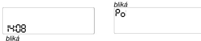
Na displeji bliká znak hodiny a svítí znaky minuty, den v týdnu. Po nastavení hodin se uloží tato hodnota do paměti tlačítkem s přechodem na nastavení minut. Po dalším stisku se uloží hodnota proměnné minuty a přejde se k nastavení dne v týdnu. Dalším stiskem dojde k uložení nastavené hodnoty do paměti a k návratu zpět do volby menu.
