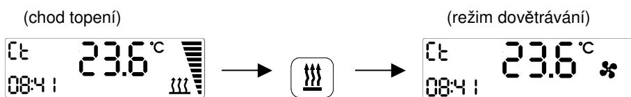
Je-li topení v chodu pak stiskem tlačítka se ukončí topení a automaticky se dovětrává na stanovenou teplotu minimálně však 2min. Tento režim je signalizován blikáním symbolu . Na displeji je v levém dolním rohu zobrazen aktuální čas a ve střední části displeje je zobrazena aktuální teplota zvoleného čidla. Během dovětrávání lze měnit nastavení hodin pomocí menu. a lze též krátkým stiskem tlačítka zobrazit teplotu venkovního čidla teploty. Po dovětrání přejde topení do klidu.
